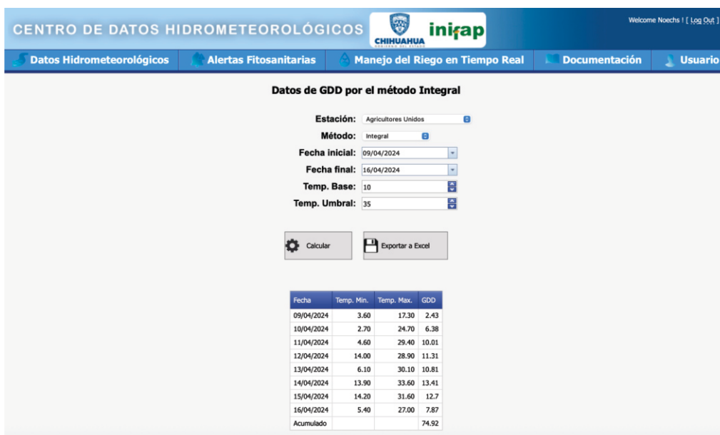
Figura 9. Menú para el cálculo de GDD, selección de la estación, método, temperaturas umbrales, periodo de análisis y tabla de resultados.
