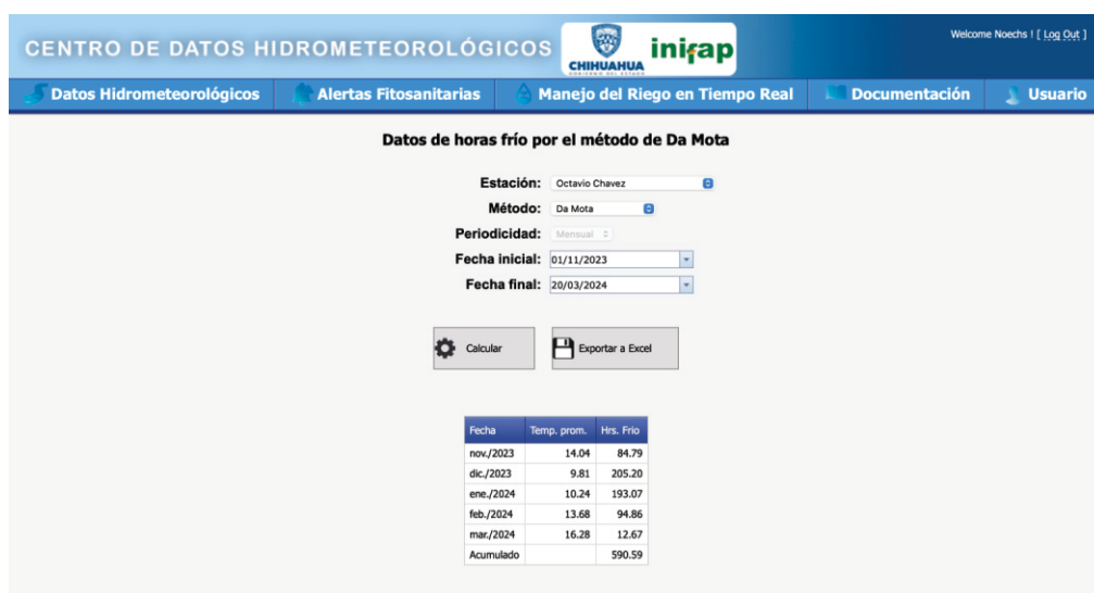
Figura 10. Menú para el cálculo de horas frío, selección de la estación, método, periodicidad, periodo de análisis y tabla de resultados.
